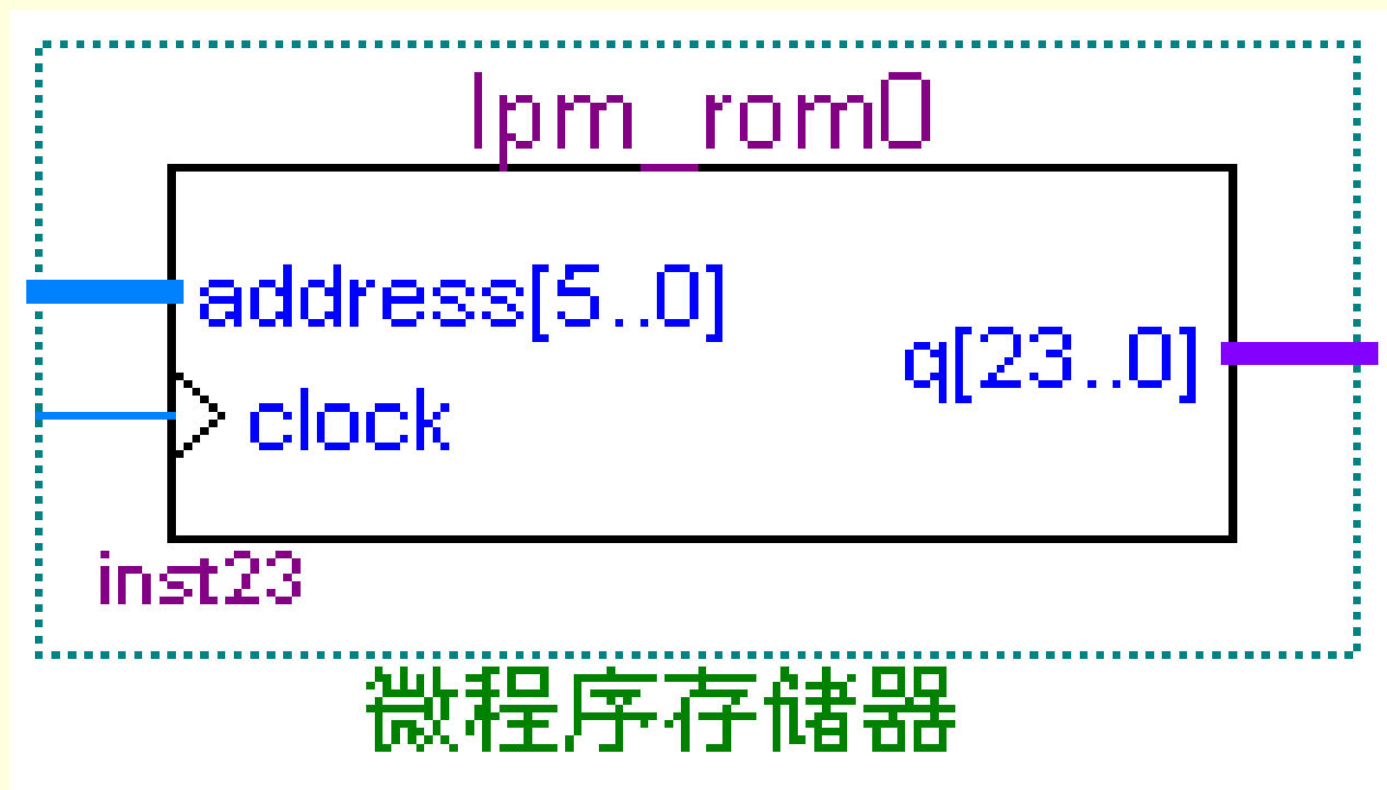
图4-15 LPM_ROM的结构图
