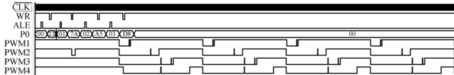
图 8-9 四通道 PWM 信号发生模块时序仿真波形图
