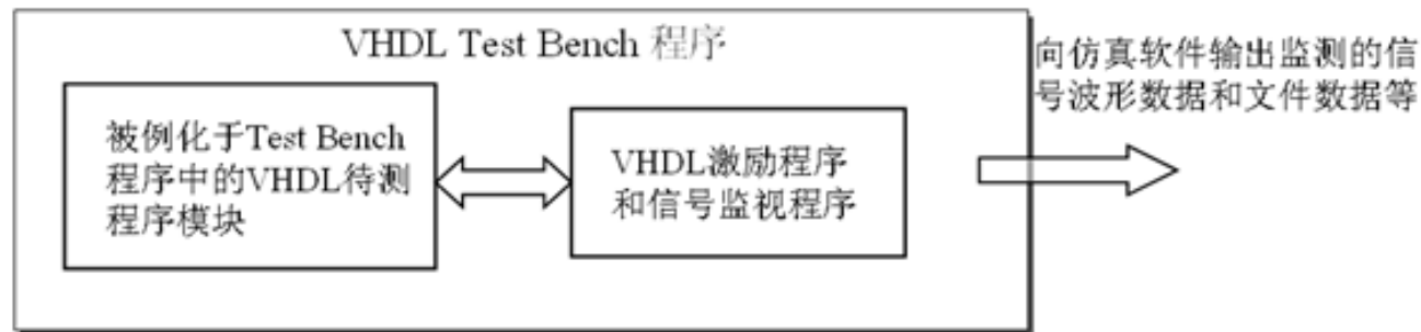
图 10-3 VHDL Test Bench 结构
