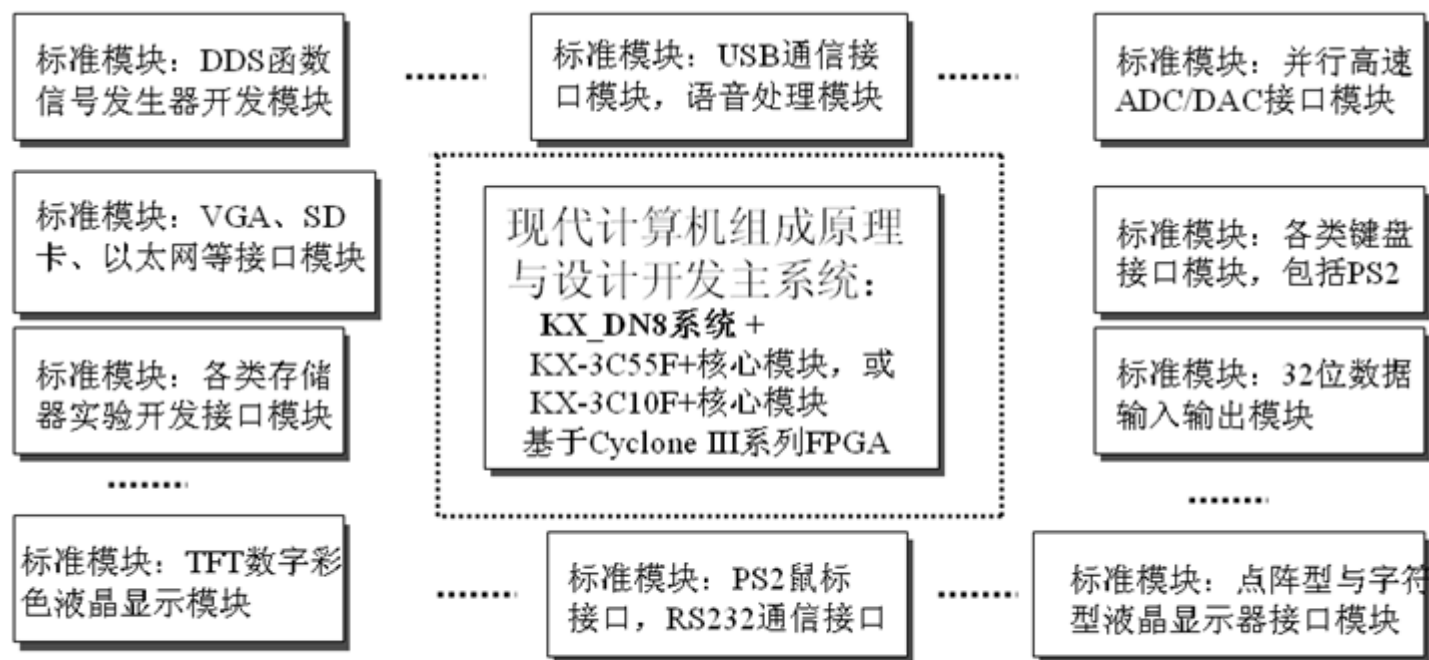
图 A-1 模块化创新设计计算机组成原理实验系统结构示意图
