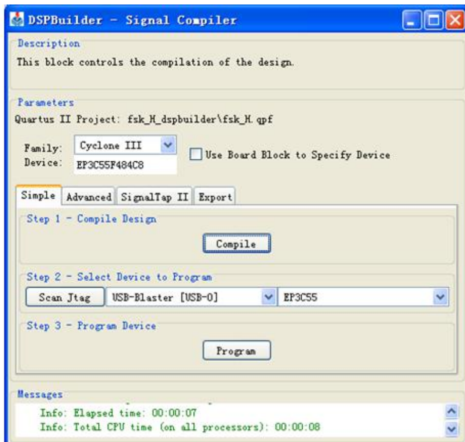
图 11-57 SignalCompiler 对 FSK 信号发生器进行转换、综合和适配
