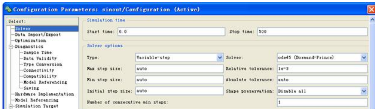
图 11-21 Simulink 仿真设置
