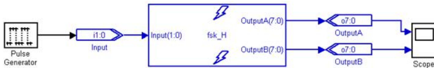
图 11-61 加入了 HIL 模块的扫频滤波电路模型
