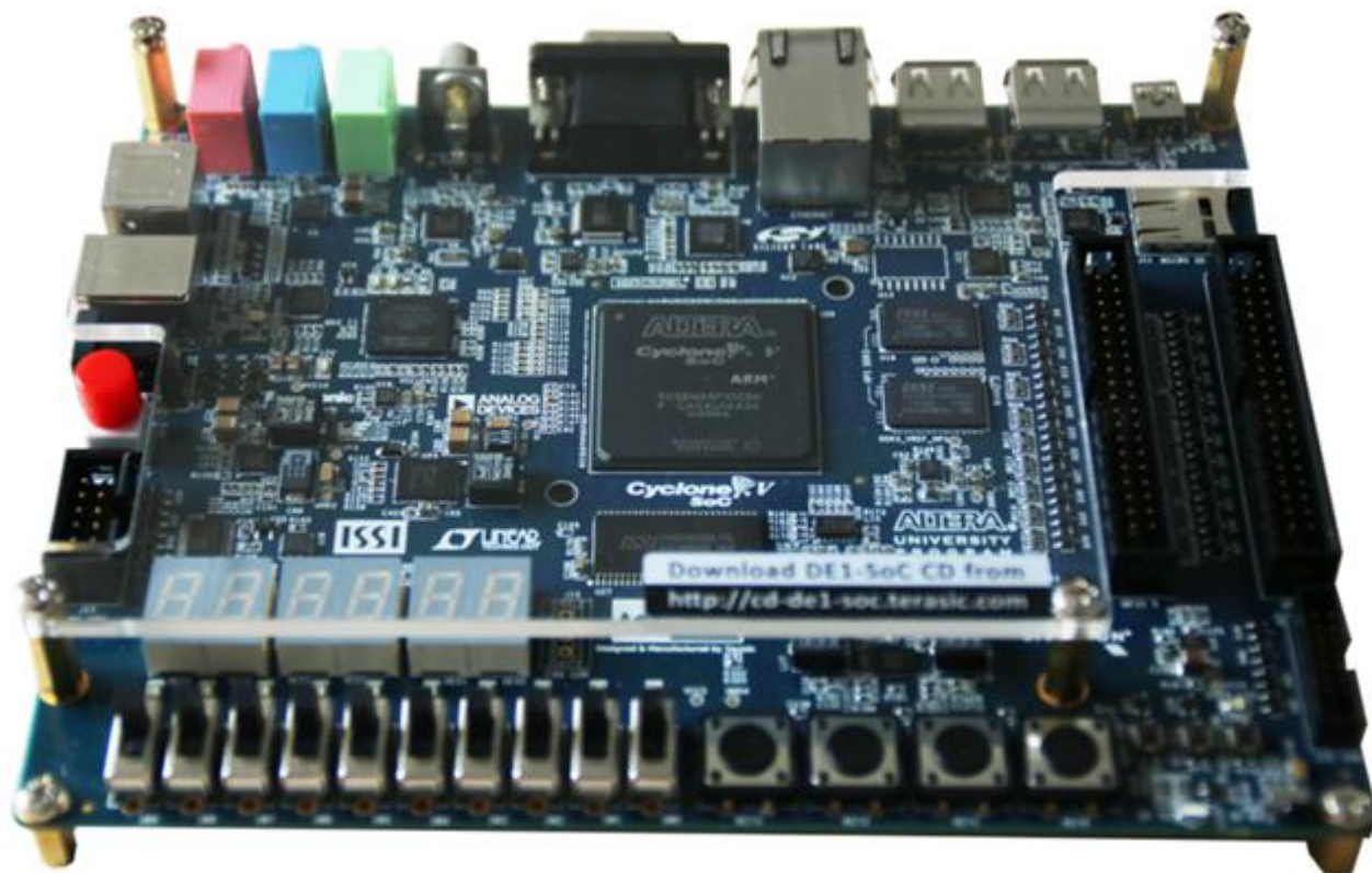
图 A-4 KX_CDS 系统核心板：有晶公司 DE1-SOC 板，配有 Cyclone 5 型 FPGA: 5CSEMA5F31C6N
