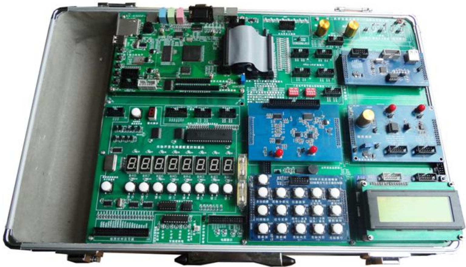
图 A-1 康芯 KX-CDS 主系列平台，图中显示的核心板是有晶的 DE1-SOC（左上侧）
